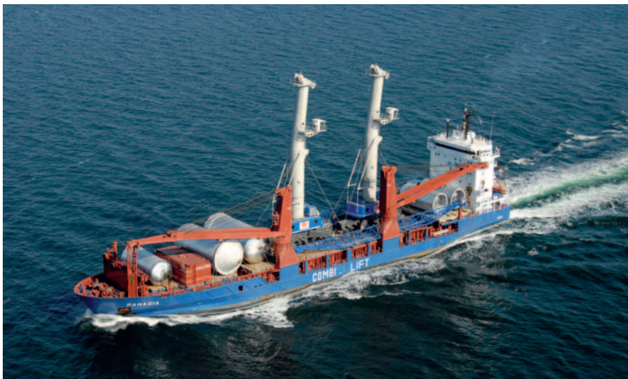
Weltweit für Combi Lift K/S in der Projektfahrt im Einsatz: Die 2004 gebaute „Panagia“ mit einer Tragfähigkeit von 7821 Tonnen erreicht eine Dienstgeschwindigkeit von 16,5 Knoten
