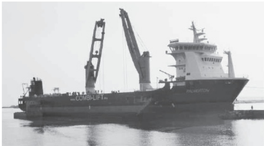
MS „Palmerton“ ist mit zwei 450-Tonnen-Kranen des Herstellers Liebherr ausgerüstet
