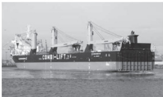
Dockschiff mit drei Schwergutkränen: „Combi Dock IV“
