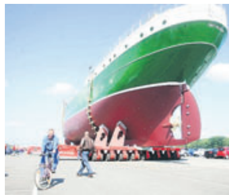
Auf selbstfahrenden Achsen bewegt sich die „Alex“ über den Egerland-Parkplatz zur Pier.
