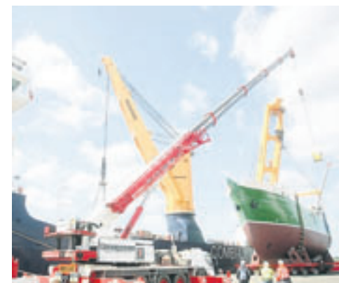
Schiff hebt Schiff. Zuvor wird das Schwergut-Ladegerüst an der „Alex“ befestigt.
