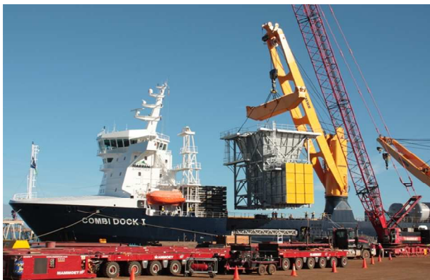
Ladungsteil „PAU 11104“. 23 m lang, 16 m breit, 21 m hoch, 316 t schwer.
